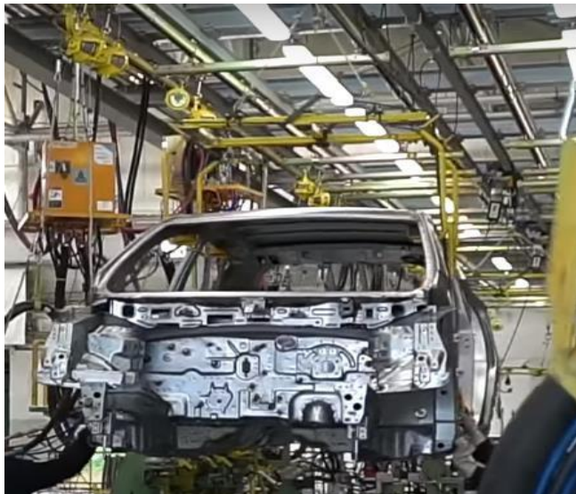
1.6 - сурет - «СарыарқаАвтоПром» зауытында қолданылатын КВК типті крандар
