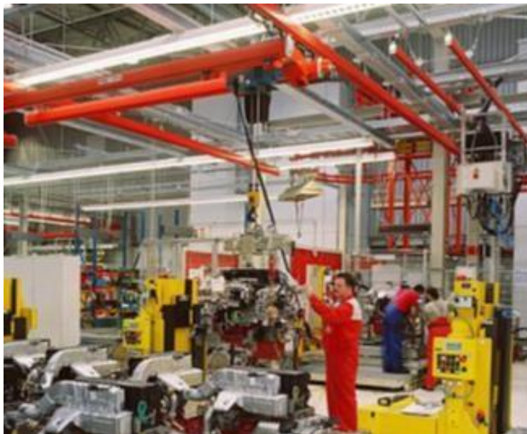
1.2 - сурет - Автомобильдерді құрастыру процесінде пайдаланылатын екі арқалы көпір краны
