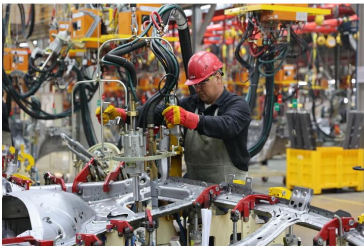
1.7 - сурет - Құрастыру желісінде дәнекерлеу сапасын бақылау процесі
