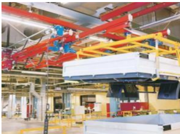
1.3 - сурет - Тіркемелерді құрастыру үшін пайдаланылатын жебесі бар кран, тиеу орнын құрастырумен жалғау
