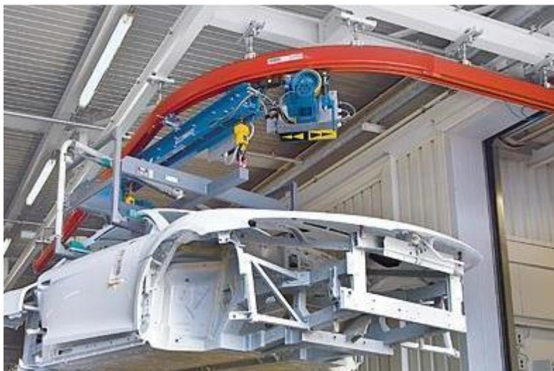
1.1 - сурет - Кузовты өндірістік желі бойымен тасымалдау процесі
